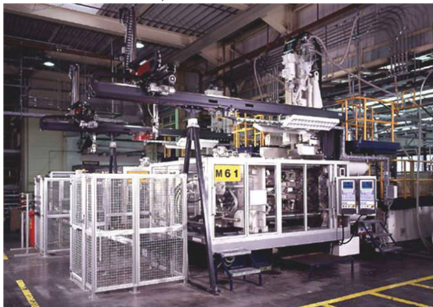
1. ábra Három komponensű KraussMaffei fröccsöntő gép Forrás:KraussMaffei ismertető
